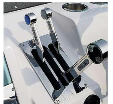
Wasser marsch! Der linke Hebel dient zum Füllen des Ballasttank
