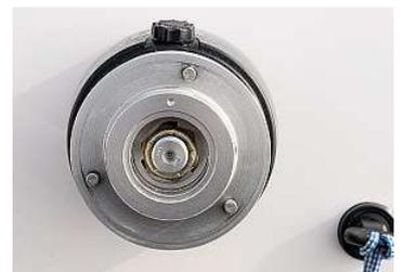
Diebstahlschutz: Das Lenkrad ist mit einem Griff abzunehmen
