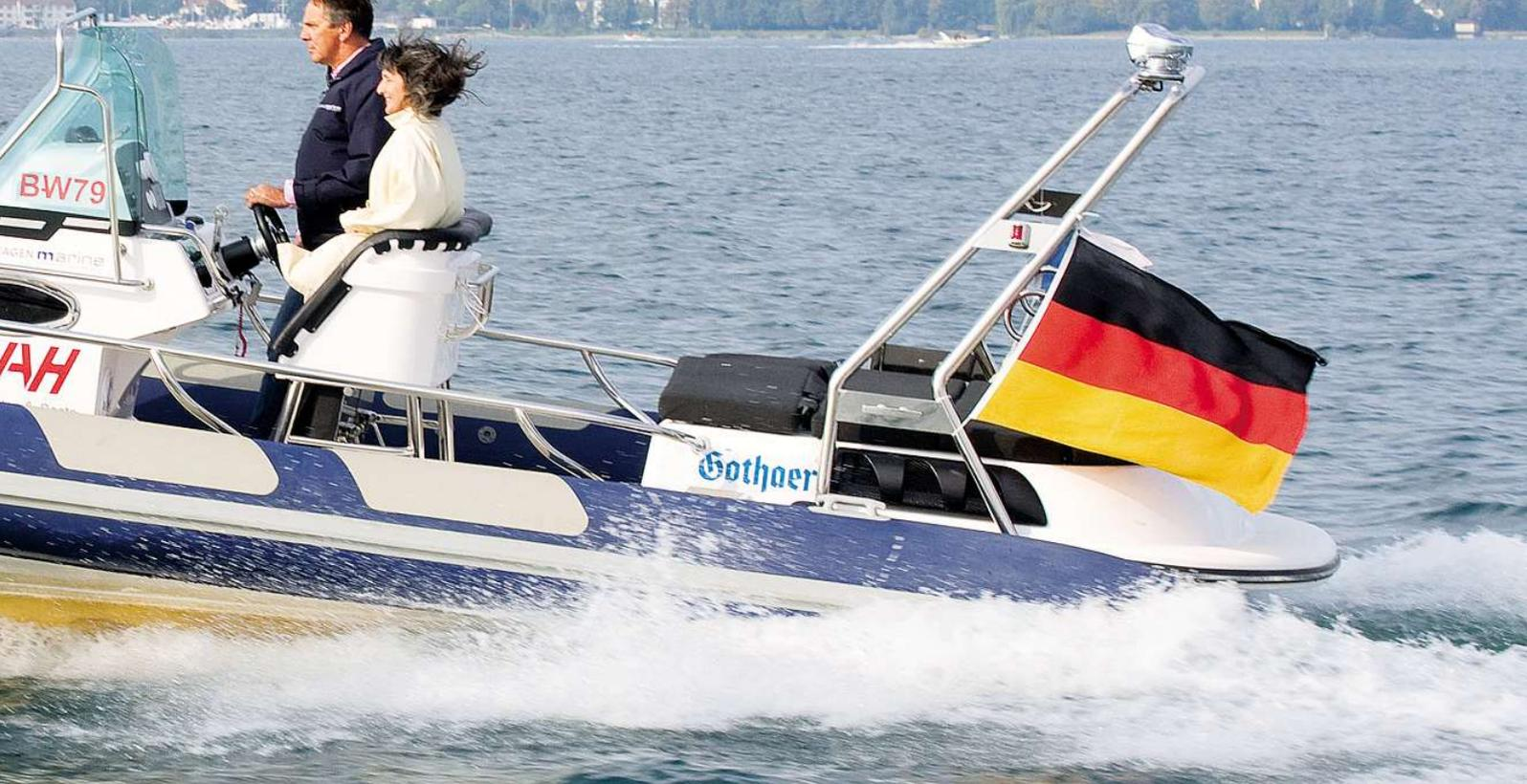
man trittsichere Einstiegshilfen angebracht. Die Lehne der Hecksitzbank kann im Handumdrehen umgesteckt werden. Mit Hilfe eines Einlegeteils entsteht dann über dem Motorraum eine großzügige Sonnenliege. Erwähnenswert ist auch die formschöne Edelstahlreling, die im Cockpitboden sicher verbolzt angebracht ist. So steht im gesamten Boot stets ein solider Handlauf zur Verfügung. Im Bug macht sich ein großer belüf-
